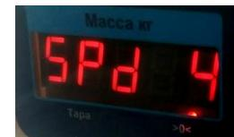
4. С помощью клавиши [Ввод] или [Реж] входим в режим настройки весов. Отображается "VESoV". С помощью кнопки [T] найдите и выберите режим выбора протокола обмена. В момент отображения на весовом дисплее сообщения "PRoT", нажмите клавишу [+].
