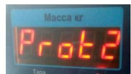
5. С помощью клавиши [Ввод] или [Реж] входим в режим настройки весов. Отображается "VESoV". С помощью кнопки [T] найдите и выберите тип канала обмена данными. В момент отображения на весовом дисплее сообщения "net", нажмите клавишу [+]. С помощью кнопки [T] выберите канал обмена данных "nEtrS". Для подтверждения выбора, нажмите клавишу [Ввод] или [Реж].
